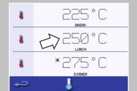
Un astérisque à côté de la valeur de température indique la température actuelle de l'enceinte. Sélectionner la température d'enceinte nécessaire pour le profil de cuisson, par exemple 250 °C / 482 °F. Lorsque l'enceinte atteint la température requise, poursuivre à partir de la sélection du « Livre de cuisine » à l'étape 1.
