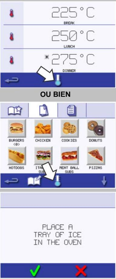
En « Mode service complet » (« FULL SERVE MODE ») ou « Mode service rapide » (« QUICK SERVE MODE »), sélectionnez le symbole du thermomètre bleu pour désactiver le chauffage et démarrer le cycle de refroidissement. Un message d'invite apparaît.
